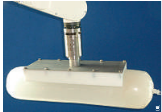
Der Vakuumbreifer DIL-HDHF mit einem Greifwerkzeug zur Handhabung von großen Würsten – im Bild mit einem Dummy.
