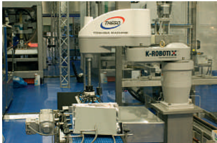
Scara-Roboter wie dieser Toshiba TH 650 sind ideal für das Einlegen versandfertiger Trays in Transportkisten geeignet.
